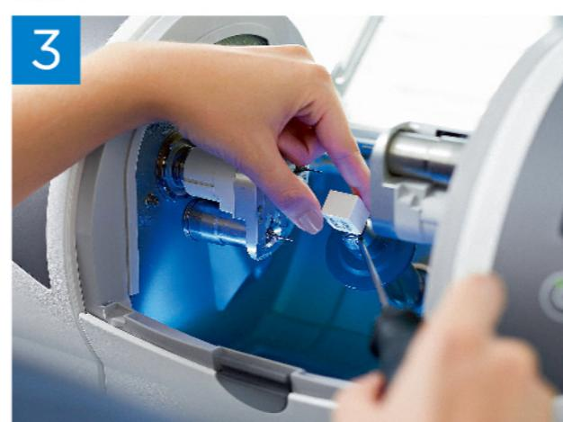
■ 自動化CAM研磨策略，無論任何材料都能輕鬆一鍵搞定。雙針同步快速研磨，平均每單位研磨約8-10分鐘，是能夠Chair-side 當日完成的核心技術。
