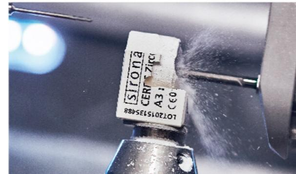
■ 除了濕式的加工模式外，特別針對氧化鋯材料進行乾式研磨加工，以避免氧化鋯燒結急劇收縮造成影響，確保氧化鋯修復體結構更為堅固，且能符合鄰床當天完成的需求。
